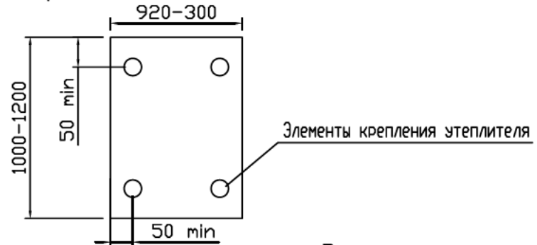
Схема крепления утеплителя на углу здания
